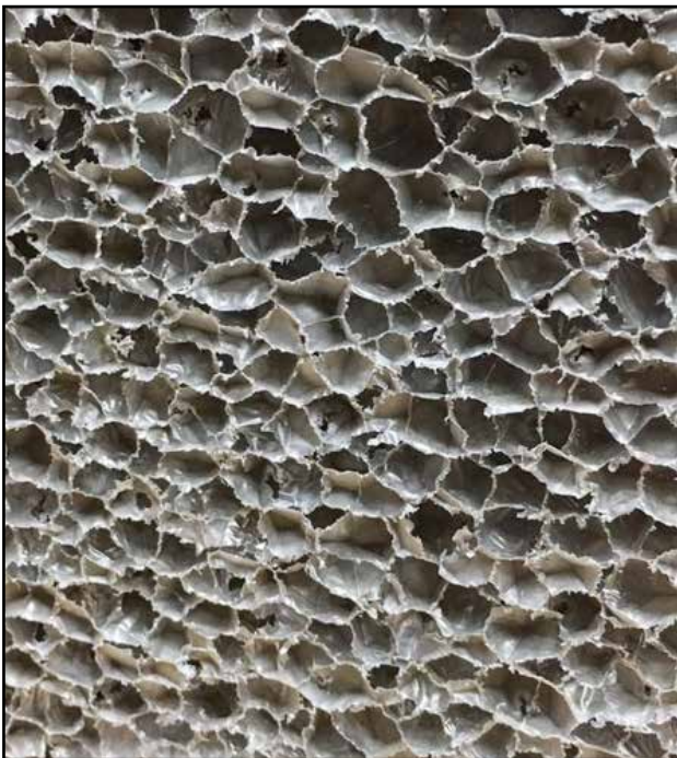
B-FEX NR ingrandimento struttura cellulare irregolare
